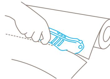
Beim Schneiden von Folien- und Papierbahnen darauf achten, dass das Schneidmaterial **unter Spannung** steht.
